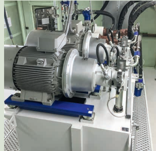
▲ Durch variable Drehzahlen und eine elektrohydraulische Regelung des Schwenkwinkels erreichen die Axialkolbenpumpen der drehzahlvariablen Pumpenantriebe Sytronix DFN optimale Wirkungsgrade.
