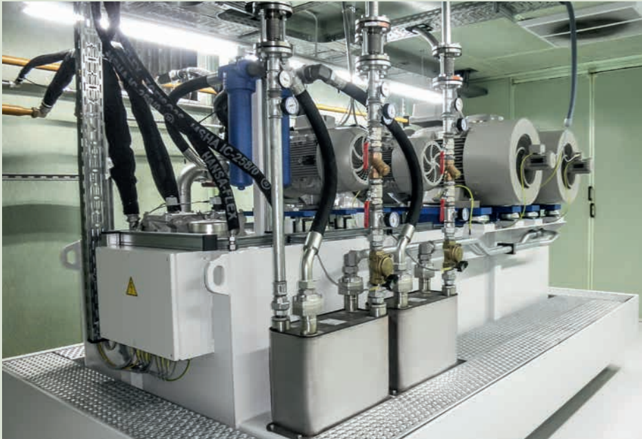
▲ Mit zwei parallelen Pumpenantrieben erreicht GKN Driveline eine kaskadierte Hydraulikleistung.
