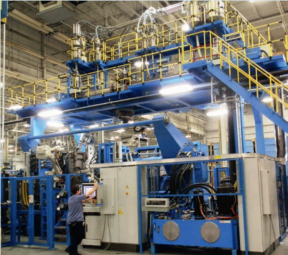
▲ TI Automotive setzt neue Maßstäbe. Mittels adaptivem Fertigungsprozess „Tank Advanced Process Technology (TAPT)“ stellt das Unternehmen verschiedenste Kraftstofftanks her.
